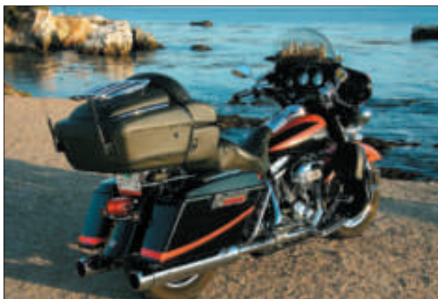
Motorurin er ein 2 syl. 4-takt V-motorur við ESPFI-innspræning og 135 hk
