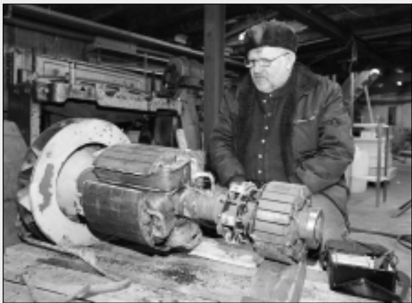
Gamli generatorin á nátaskipinum, Mai, futtaði av. Tí er Tórhallur Hansen á El-Talvuvirkinum komin upp í leikin. — Koparvindingarnar fóru, og tað sler ímillum og yvir í stell, sigur abbin á el-talvuvirkinum. Generatorurin verður kolldømdur, og teir fara at seta nýggjan í.
