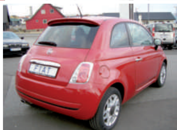
Originali Fiat 500 frá 1957 hevði motorin aftan og var drivin av bakhjólunum, meðan hesin nýggi hevur motorin framman og verður drivin av forhjólunum
