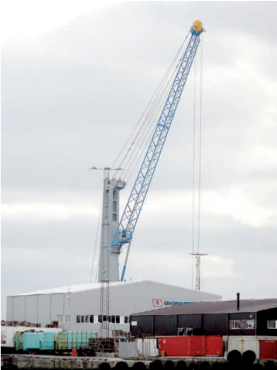
Risastóri kranin vigar umleið 400 tons og lyftir eini 120 tons
