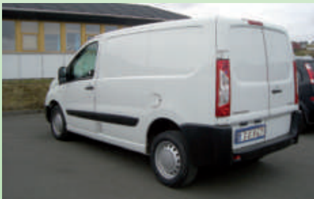
Vörurúmið er fimm rúmmetrar stórt og arbeiðsligt. Dragihurð eru í høgri síðu, og aftan eru tvær stórar hurðar
