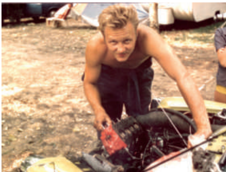
Alan kennir alt til Mini. Her hevur hann toppstykkið á motorinum av og skiftir topp-pakningin. Arbeiðið verður gjørt á einum kampinplássi við Gardarsjógvn í Italia í 1972
