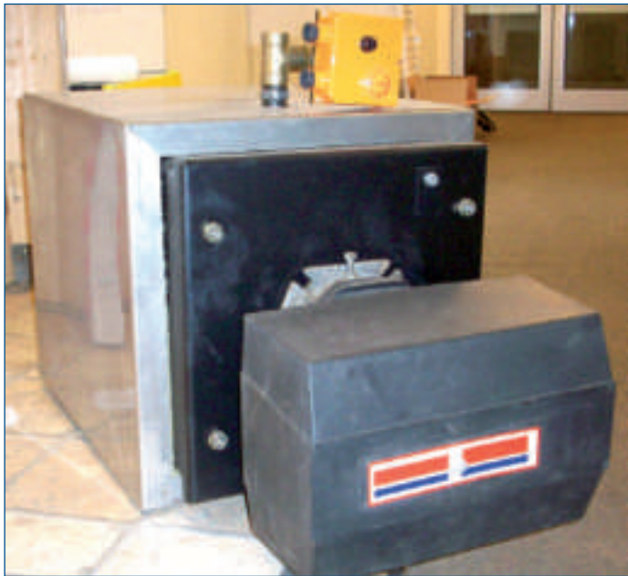
Soleiðis sær litli ketilin út, sum Hógv framleiðir til skip og bátar. Ketilin er bygdur til vanligu oljufýr
