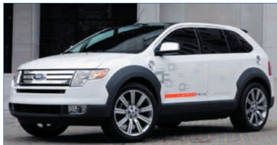
Ford Edge. Hybrid skipan við PEM brennikyknu, stødd ikki upplýst, Lithium Ion battari á 336Volt. Ein vetnistrýstflaska á 350bar við 4,5kg vetni. Koyring við einari áfylling 360km, mesta ferð 140km/tíman
