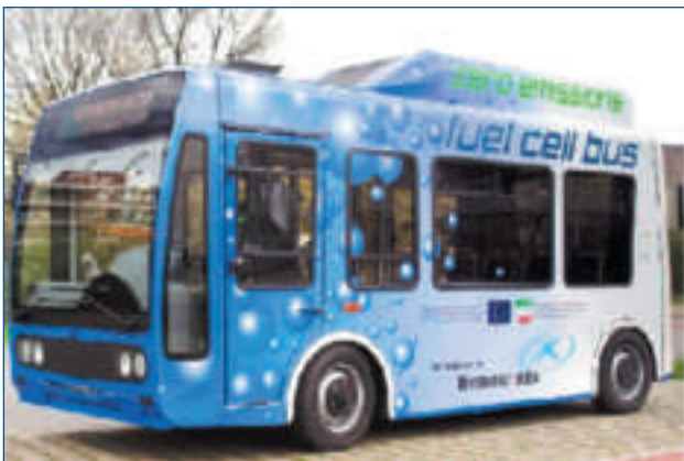
Hydrogenics Midi bussur við 12 sitiplássum, eitt til røðslutarnað og 10 standipláss. Hybrid skipan við 12KW PEM brennikykju og Nikkel Cadmium battari á 72V við 125Ampertímar. Vetnistangin er tvær trýstflöskur á 350bar við í alt 5,8kg vetni. Koyring við einari áfylling 200km, mesta ferð 33km/tíman. Væl hóskandi til býarkoyring
