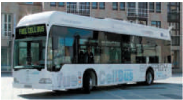
Daimler Chrysler Citaro bussur til 70 ferðandi. Orkuskipan við einstakari 250KW brennikykju frá Ballard Power Systems. Vetnisgoymslan er 8 trýstflöskur hvør á 230 litur á 350bar. Koyring við einari áfylling er 200km, og mesta ferð 80km/tíman
