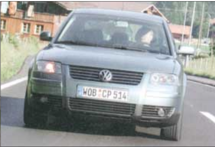
Nú fæst VW Passat við 275 hk W8 motori. Uttan er einasti munurin at hann hevur dupult útsoyt, Xenon forlyktir og dekkstøddin er 225/45-17".
