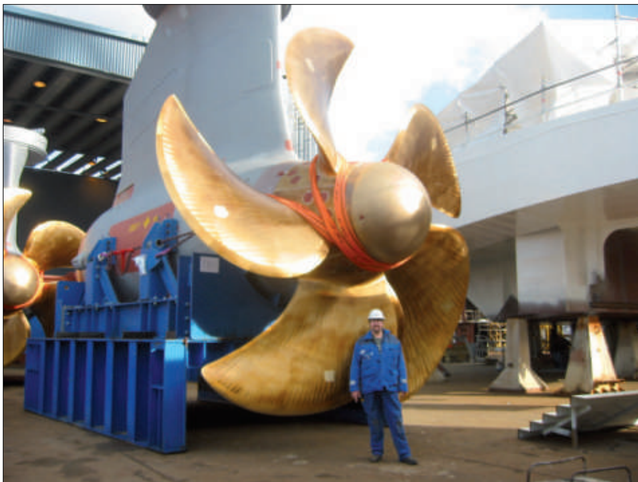
Jón Dahl Joensen frammanfyri eina Azipod skrúvu, vektin er á skrúvui er eina 235 tons
