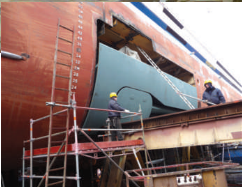
Teir nýggju stabilisatorarnir sita heldur niðari á skipssíðuni enn teir gomlu
