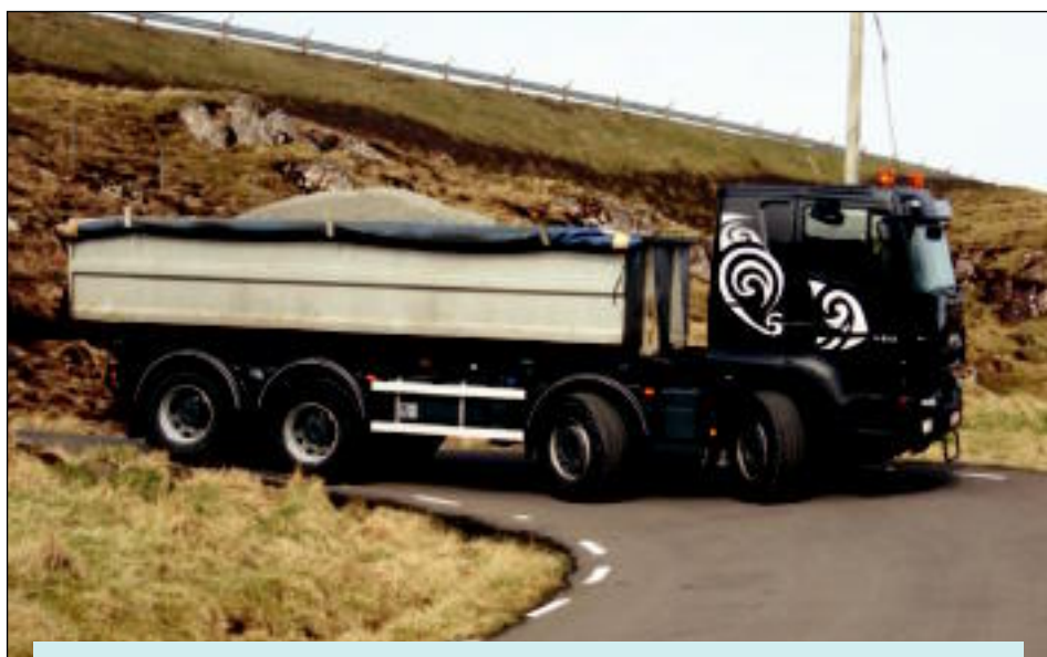
Testbilurin er ein Trakker 8x4 við 4-akslum við 32-tons wireheis og skiftilast
