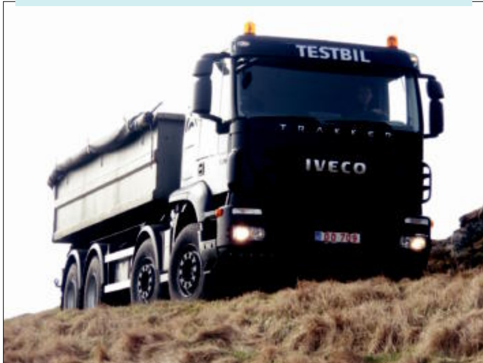
Testbilurin er ein Trakker 8x4 við 4-akslum við 32-tons wireheis og skiftilast
