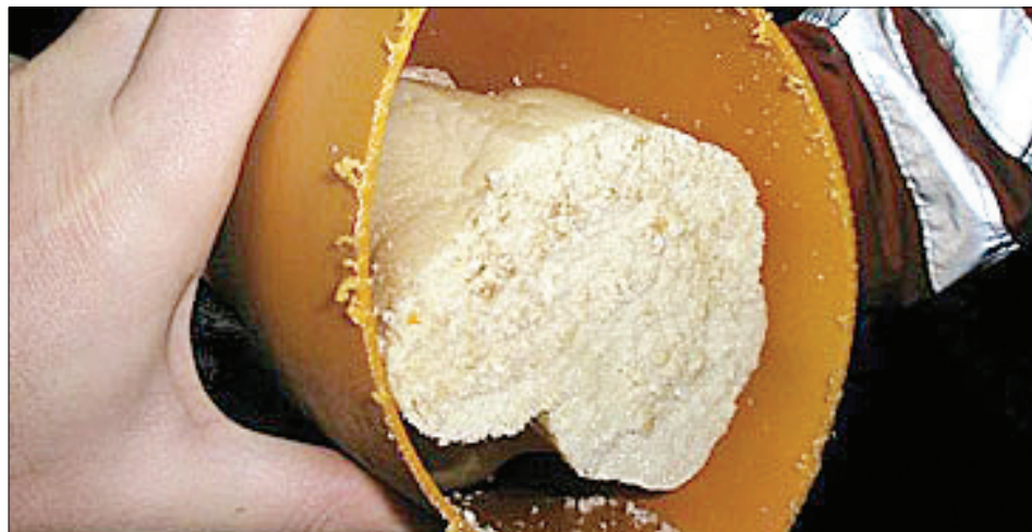
Orsøkin til, at bjargingarringar av merkjunum Aval, Perry Buoy og Valeria San Giorgio kunnu søkka, er, at skúmið inni í ringunum tódnar eftir nøkur ár, og vatn tí fer pláss í restini av ringinum
