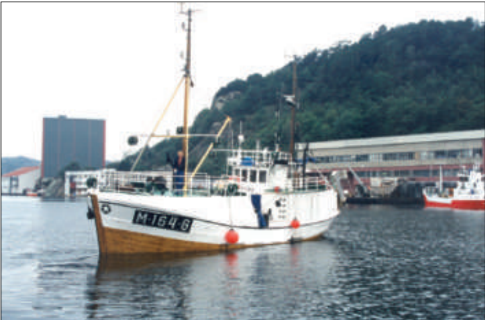
Soleiðis eru bátarnir í Noregi riggaðir til dyrking eftir makreli. Føroysku bátarnir eru riggaðir á líknandi hátt, men allir hava ikki líka nógvar dergir sum teir norsku
