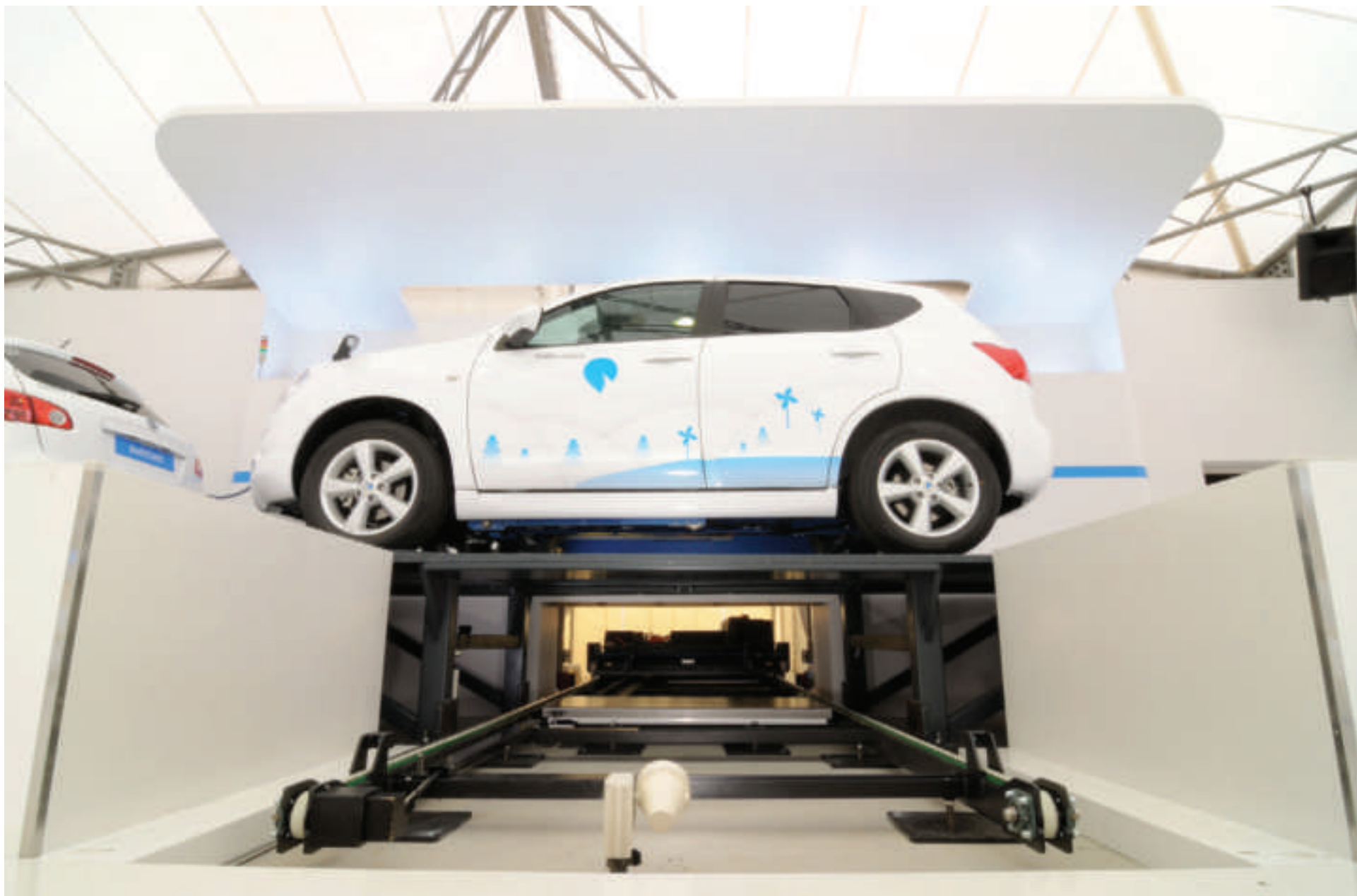
Bilurin koyrir inn yvir eina grøv, og síðan er tað ein automatisk skipan, sum skiftir batteríini
